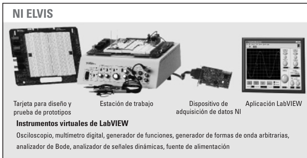
▲ FIGURA C-3 Componentes de NI ELVIS.
