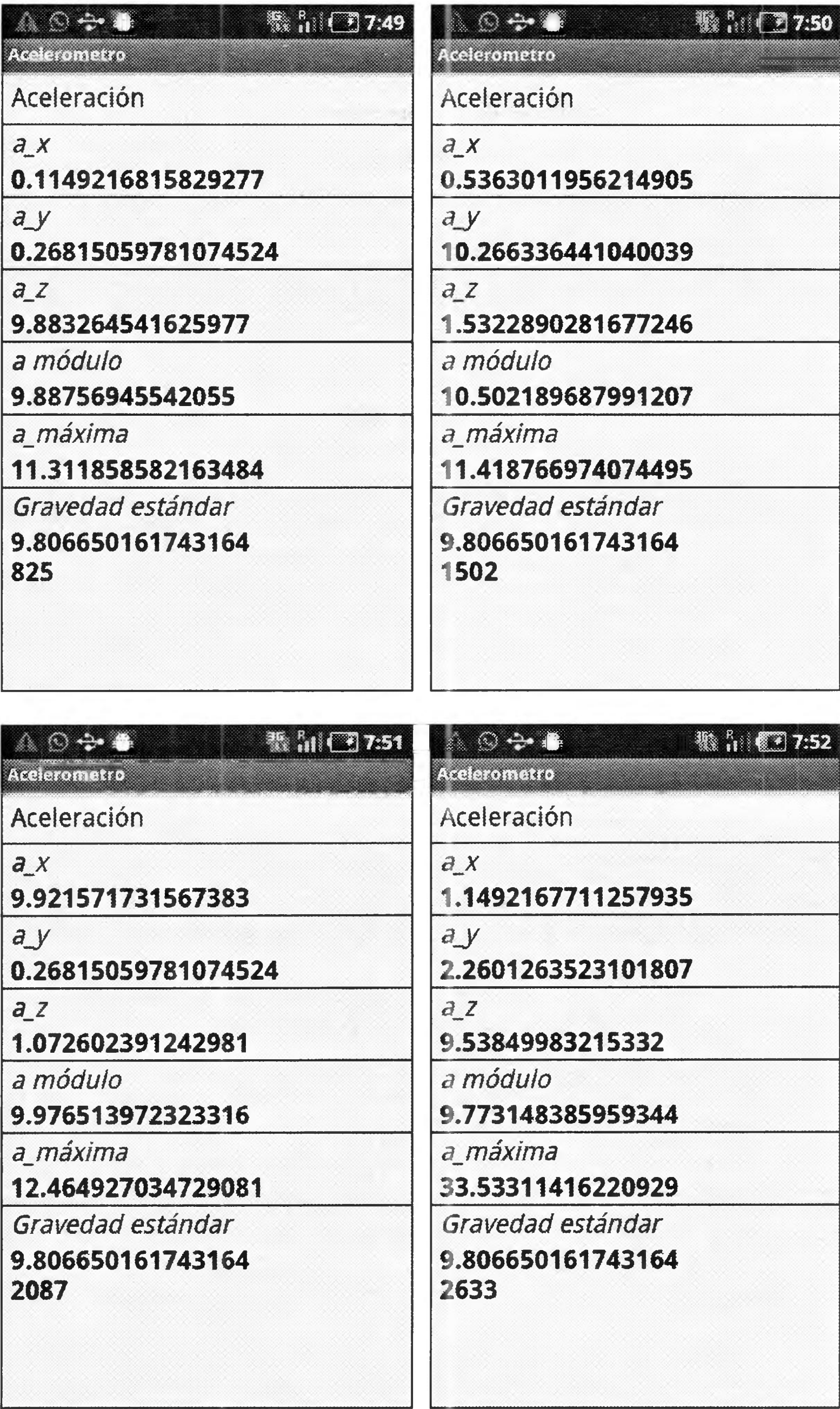
Figura 5.1. Medidas del sensor de aceleración con un teléfono Samsung Galaxy S.
